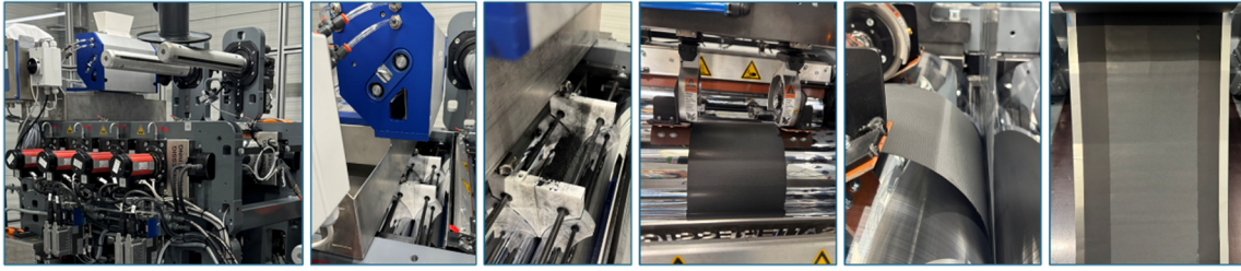
Abbildung 18: Bilder während des Dosierprozesses mit dem Rollendosierer von der Firma Coperion K-Tron sowie während des Schichtbildungs- und Laminationsprozesses mit dem ProLiT-Kalender von der Firma Saueressig/ Matthews Engineering (erstellt von M. Nickl)
