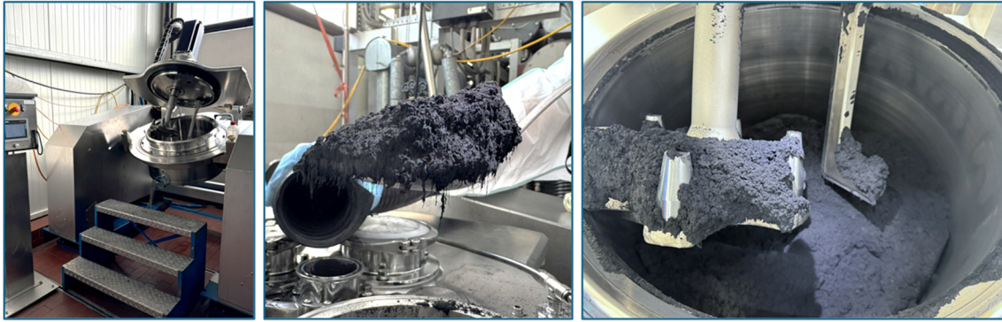
Abbildung 16: Dargestellt sind Bilder während des Batch-Mischprozesses im 50L-Eirich-Mischer bei der Maschinenfabrik Gustav Eirich GmbH & Co. KG
